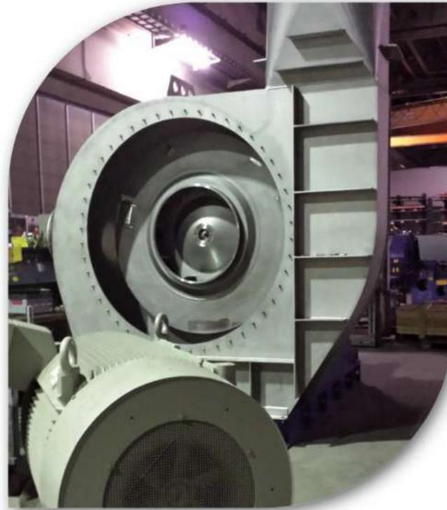
При механической рекомпрессии паров образующийся пар (насыщенный пар) из испарителя с помощью MVR-воздуходувки поднимается до более высокого уровня давления и в виде греющего пара снова подается в испаритель. Таким образом, воздуходувка работает как тепловой насос.
